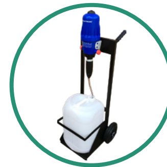
Dosatron mit Trolley Der Dosatron wird in die Wasserleitung eingebaut und gibt den voreingestellten Prozentsatz an Reinigungs-/ Neutralisierungsmittel in das Wasser ab.
