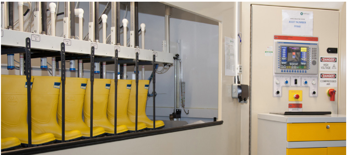
Dielektrische Stiefel im Test in der Workmaster™ Stiefelfabrik
