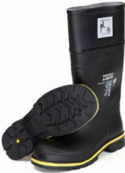
Une botte résistante à la chaleur conforme à la norme EN 15090 HI3 F3A sur les chaussures de protection pour pompiers, protège des flammes, de la chaleur radiante (20 kW/m<sup>2</sup>), avec semelle résistante à la chaleur (250°C pendant 40 minutes). Nos bottes Isotec sont spécialement conçues pour être utilisées en cas de soudure ou d'abrasion présentant un risque d'étincelle, ou pour la lutte contre les incendies de proximité immédiate.
