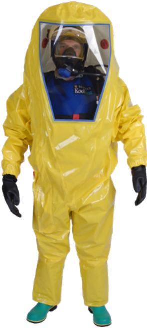
Combinaison intégrale légère, étanche au gaz, de **Type 1a-ET**, conçue pour protéger le personnel d'intervention d'urgence contre les gaz toxiques et corrosifs, et contre les produits chimiques liquides et solides.
