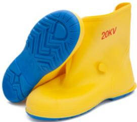
Surbotte diélectrique à isolation électrique de **classe 2** conçue pour être portée sur des chaussures de sécurité. La botte Workmaster™ diélectrique HV3 permet d'intervenir en milieu soumis à haute tension électrique allant jusqu'à 17,5 kV, chaque botte étant testée à 20 kV.
